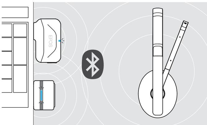
Le voyant LED du dongle clignote en bleu en mode recherche, puis passe en bleu clair lorsque le dongle est connecté au casque.
