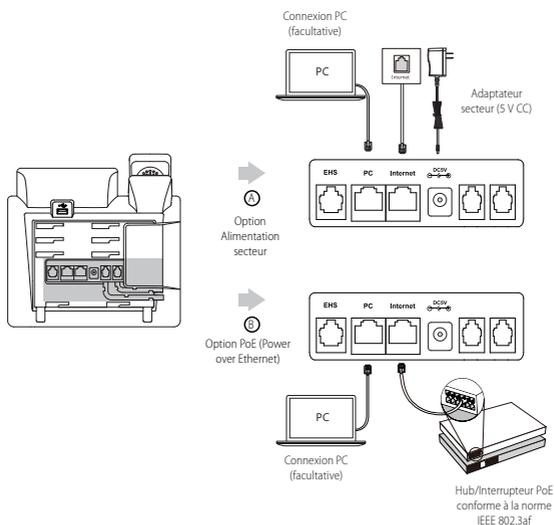
Remarque : Le téléphone IP doit seulement être utilisé avec l'alimentation Yealink (5V/1,2A) d'origine. L'utilisation d'un adaptateur secteur tiers peut endommager le téléphone. Si vous connectez un ordinateur à votre téléphone, nous vous recommandons d'utiliser le câble Ethernet fourni par Yealink. Si une alimentation en ligne (PoE) est fournie, vous n'avez pas besoin de raccorder l'adaptateur d'alimentation. Assurez-vous que le concentrateur/commutateur soit conforme au PoE.
