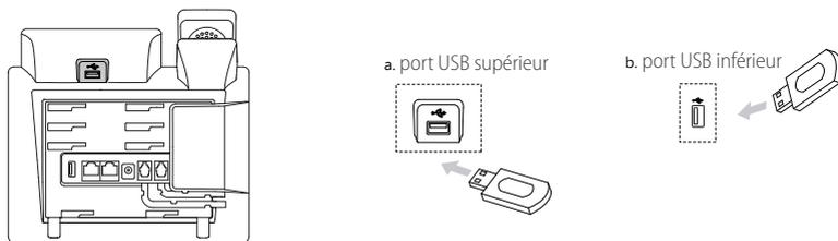
Remarque : Les ports USB peuvent également être utilisés pour connecter d'autres appareils USB, un casque USB, etc. Yealink recommande de connecter un dongle USB Bluetooth ou Wi-Fi au port USB supérieur.
